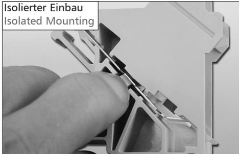
Soll das Modul nicht geerdet werden, den Rasthaken am Gehäuse nach unten drücken und die Erdungskontaktfeder entnehmen.
