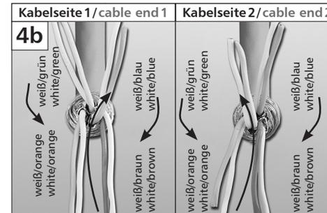
... und nach dem Bild anordnen, um die Adern später leichter in das Ladestück einführen zu können.
