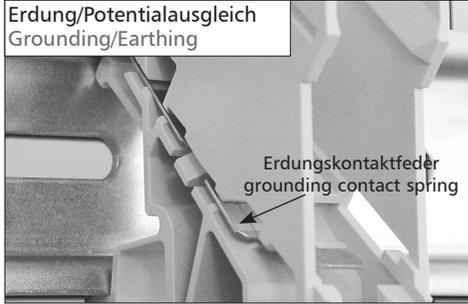
Die Erdung der Module erfolgt über die Erdungskontaktfeder direkt auf die Montageschiene. Diese wird durch eine Erdungsklemme mit dem Potentialausgleich verbunden. Montageschiene muß elektrisch leitend sein.
