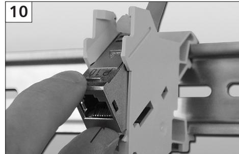
Das fertig angeschlossene 8(8) Modul in das Gehäuseunterteil des REG einsetzen.
